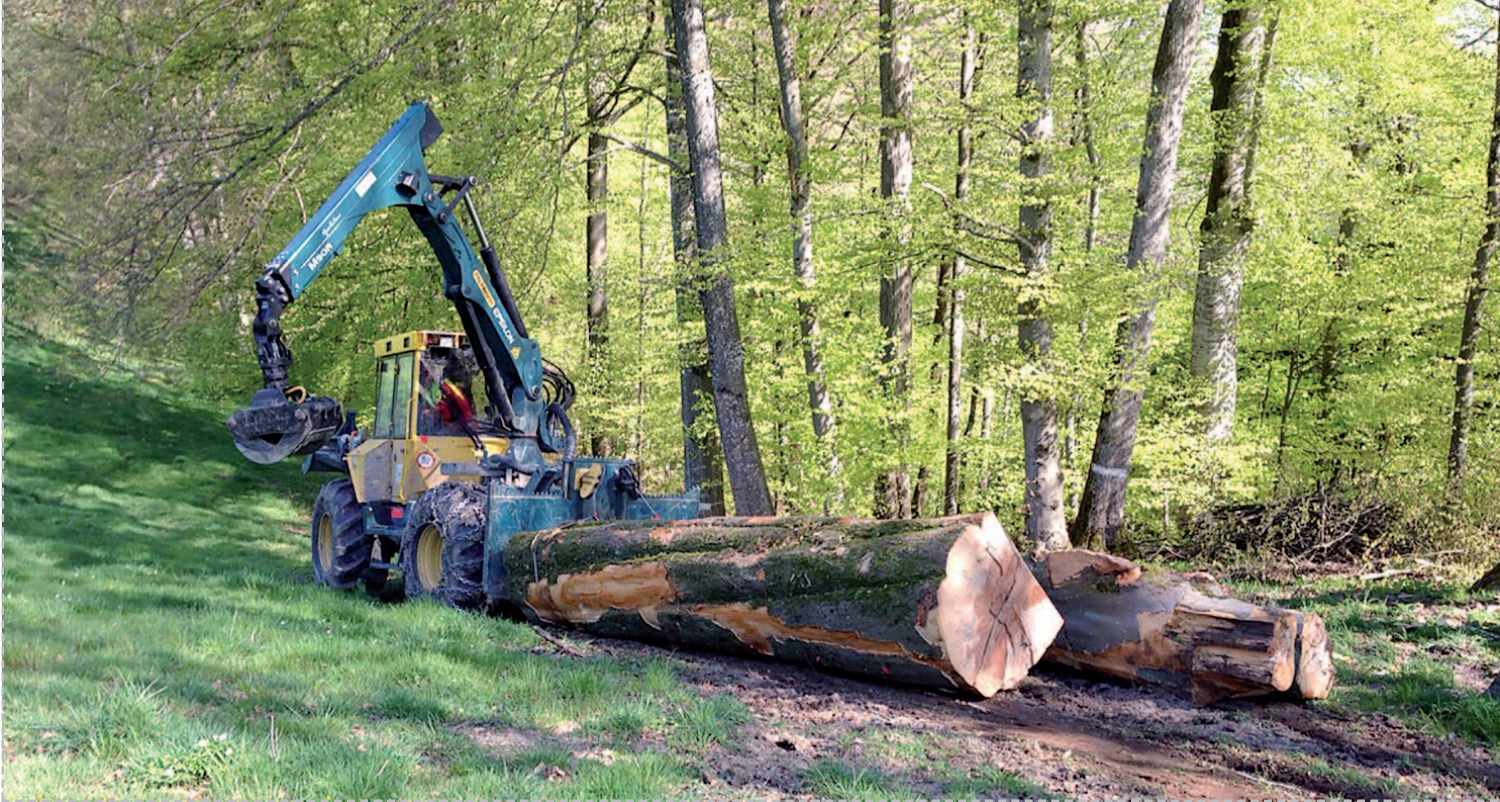
Vorrücken eines Buchenstammes mit Rückschlepper HSM 805 «Obelix»
